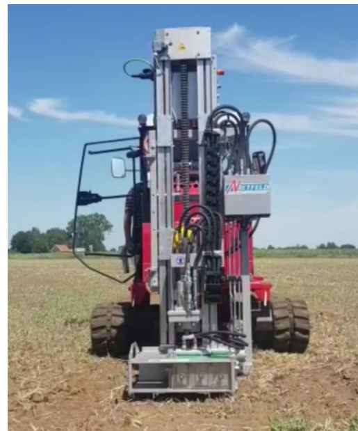
Abbildung 2: Raupenfahrzeug mit Nietfeld-Bodenprobengerät
